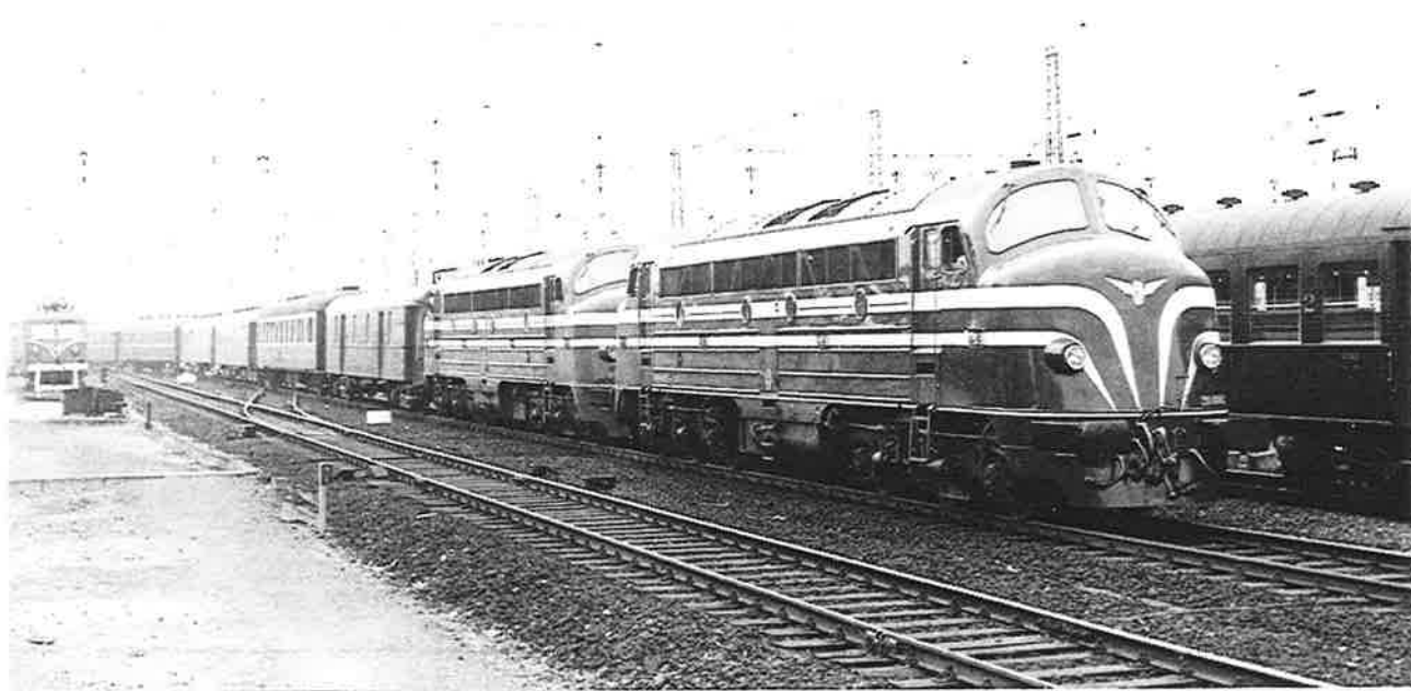
Une double traction de HLD type 204 en tête d'un train royal Paris-Bruxelles-central, le 24/06/60. (Photo Bruno De Doncker, avec l'aimable autorisation du P.F.T.)
